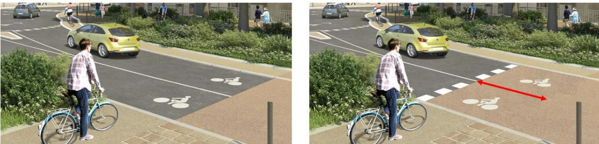
Figure 2 : à droite, extension de la partie en bitume colorée et ligne transversale discontinue blanche de cédez le passage, pour identifier clairement le passage prioritaire des cyclistes
